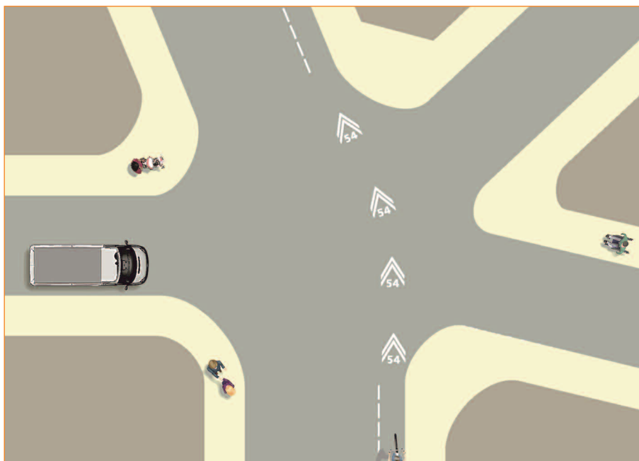
Matérialisation de la trajectoire par double chevrons + numéro d'itinéraire
